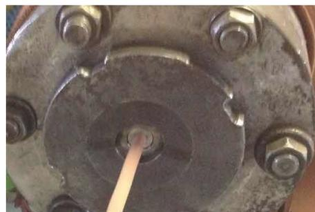
Для хорошего результата при шприцевании необходимо иметь достаточно мощную червячную машину, так хороший результат обеспечивается при шприцевании на двухчервячных машинах. Принципы конструирования оснастки для шприцевания фторэластомеров такие же, как для многих других смесей. При ее конструировании приходится учитывать особенности реологии фторкаучуков. Важным фактором является охлаждение зон машины.
