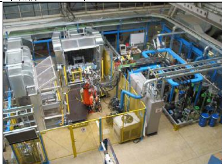
Рис. 12. Фотография системы инъекционного литья для производства автомобильных сидений; изготовитель: Cannon (фотография компании: Bayer Material-Science)
