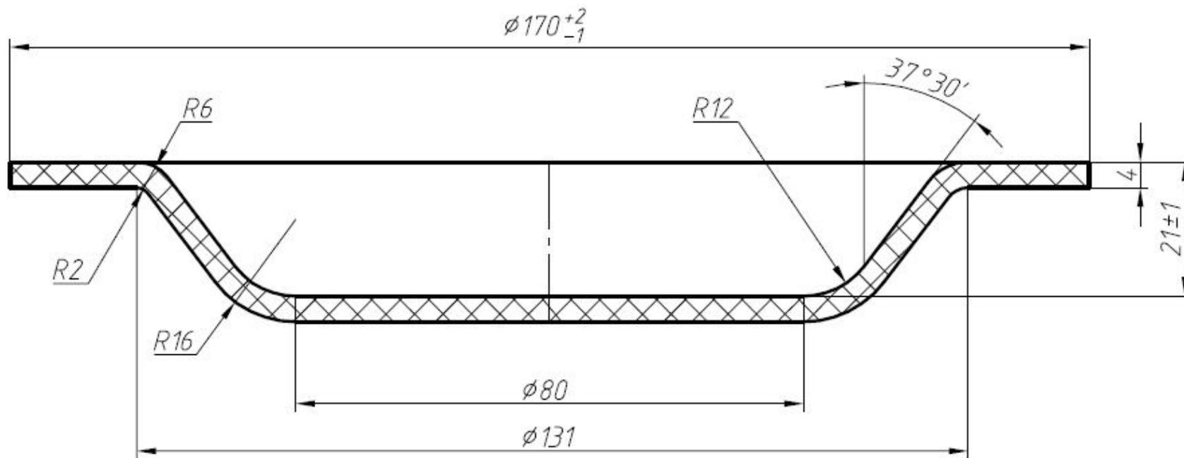
1.4. Мембрана резиноканевая клапана регулирующего фирмы «Masoneilan», пр-во Франции
